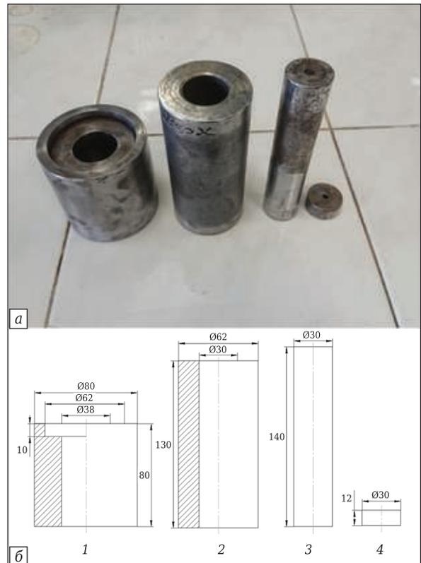
Рис. 1. Внешний вид (а) и схема формы для изготовления брикетов (б): 1 — выпрессовыватель; 2 — матрица; 3 — верхний плунжер; 4 — нижний плунжер
