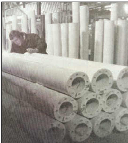
Рис. 2. Оболочки роликов печей для термообработки специальных марок листовой стали, полученные на основе ВКВС плавленного кварца центробежным методом
