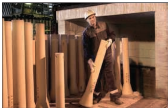
Фото 2. Теплозащитные трубы, полученные на основе ВКВС плавленного кварца центробежным методом
