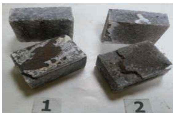
Рис. 1. Образцы соединений изделий из калиевого фторфлогопита после испытаний на терморасплавостойчивость
