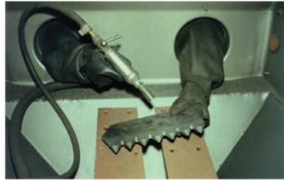
Рис. 1. Струйно-абразивная обработка перед напылением ножа колодезного бура
