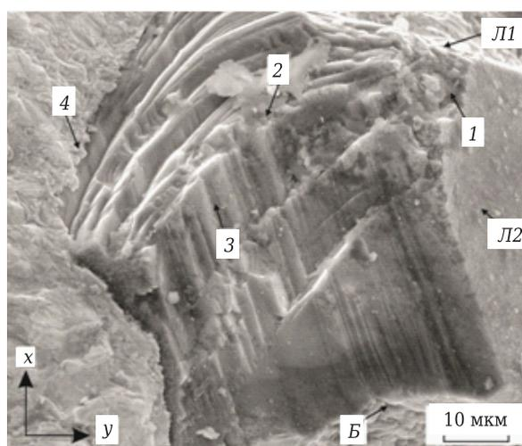
Рис. 3. Разрушение алмазного зерна по механизму макроскола
