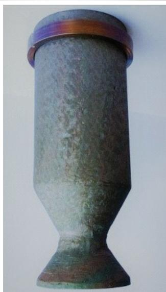
**Рис. 4.** Модельная КС из C<sub>f</sub>/SiC с переходным металлическим кольцом: а — сборочный чертеж КС [47]; б — внешний вид КС с переходным кольцом
