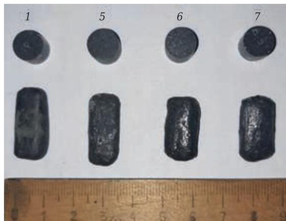
Рис. 7. Компактированные образцы (верхний ряд) и образцы графита с покрытиями составов 1, 5, 6 и 7 (нижний ряд) после нагрева в интервале 1000–1300 °С в течение 2,5 ч с 15-мин выдержкой при 1300 °С
