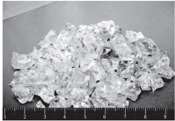
Рис. 2. Гранулат магнийалюмосиликатного стекла
