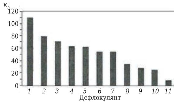
**Рис. 6.** Критерии разжижения  $K_p$  ВКВС боксита с применением добавок: 1 — Giessfix 162; 2 — M-ADS1; 3 — Dollaflux SP; 4 — M-ADS1+M-ADW1; 5 — КОМП; 6, 7 — Giessfix ZS; 8 — ADW1; 9 — Dollaflux B; 10 — Castament; 11 — ADS3
