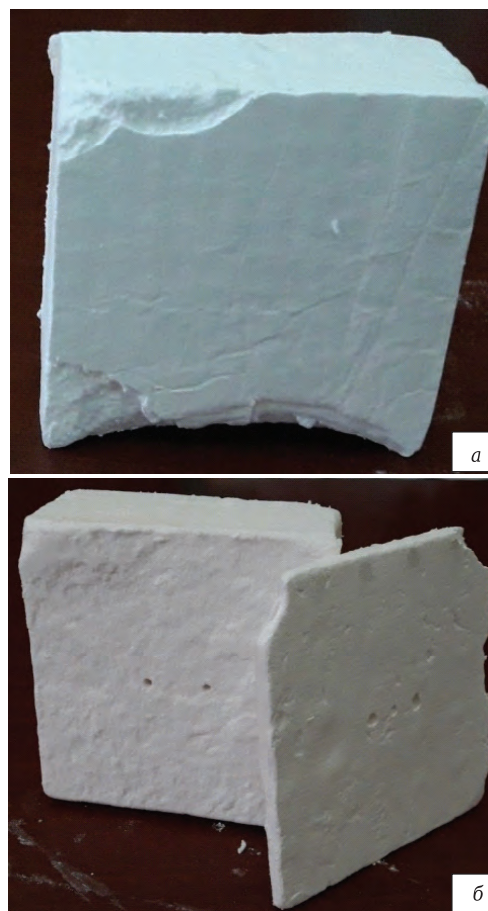
Рис. 2. Образцы теплозащитного материала ВТИ-17 после термообработки в течение 2 ч в фокусе БСП
