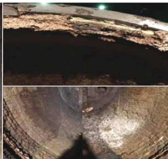
Рис. 3. Футеровка сталеразливочного ковша с нанесенным шоткрет-слоем после эксплуатации (124 плавки)
