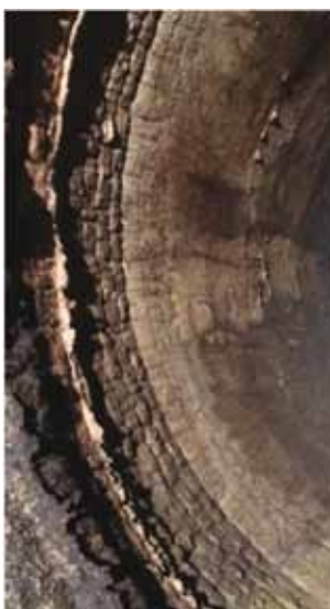
Рис. 3. Футеровка сталеразливочного ковша с нанесенным шоткрет-слоем после эксплуатации (124 плавки)
