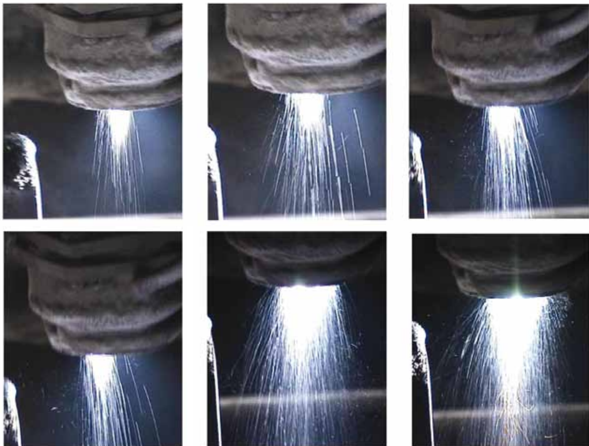
Рис. 9. Покадровый просмотр видеосъемки для определения скорости полета частиц, транспортируемых защитным газом через сопло плазматрона
