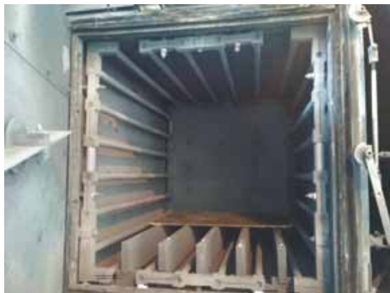
Рис. 6. Вакуумная печь для высокотемпературного газотермического упрочнения бурового инструмента. Масса загрузки 2 т; среда — диссоциированный ацетилен; фирма-изготовитель Irsop, Германия; периодически комплектуется электроизоляторами (см. рис. 5)
