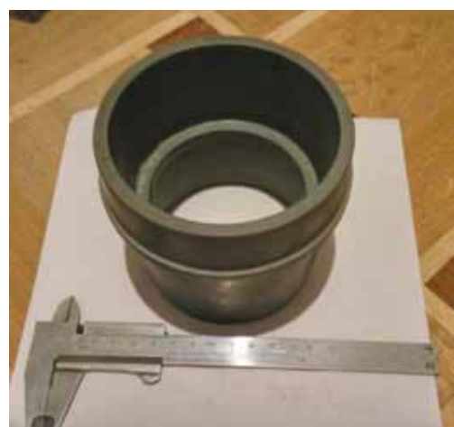
Рис. 4. Электроизолятор вакуумной установки электронно-лучевой сварки толстостенных элементов (50–100 мм) из высокопрочных алюминиевых сплавов (комплектующая электронно-лучевой пушки ЭЛА 30/60)
