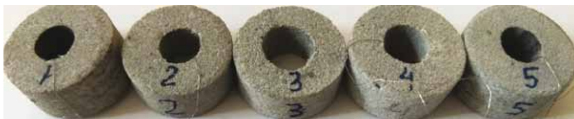
Рис. 5. Образцы для исследования пористости по длине мембраны
