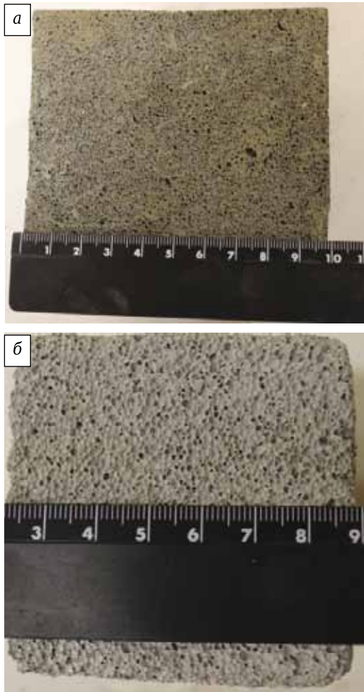
Рис. 3. Фото образцов, изготовленных по классической технологии (а) и в ЭГТСП (б)
