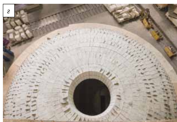
Рис. 8. Стендовые сборки в АО БКО и приемка продукции в присутствии представителей АО «КАЛУГИН» и АО ЕВРАЗ НТМК: а — штуцер горячего дутья; б — нижняя арка штуцера; в — совместная инспекция; г — комплект купола
