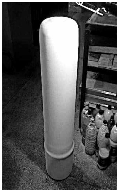
**Рис. 5.** Полноразмерная проницаемая диафрагма с канальной пористостью
