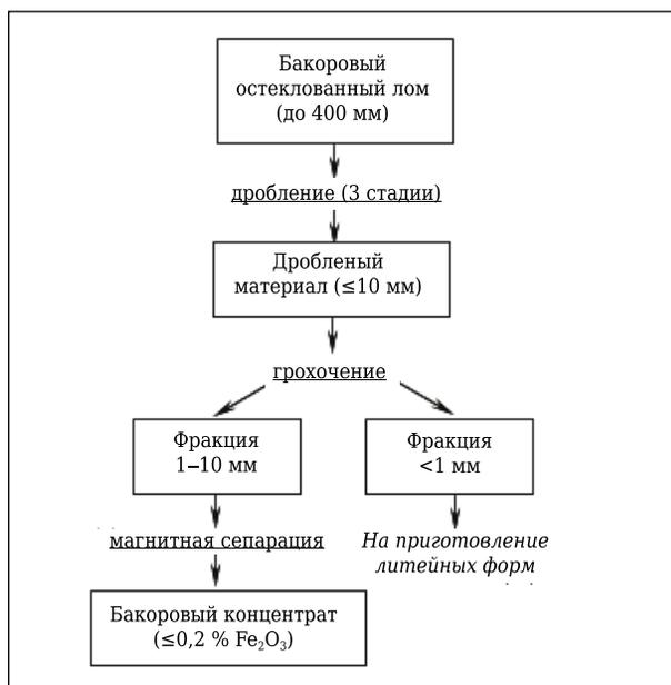
**Рис. 4.** Принципиальная схема переработки лома остеклованных бакоровых огнеупоров
