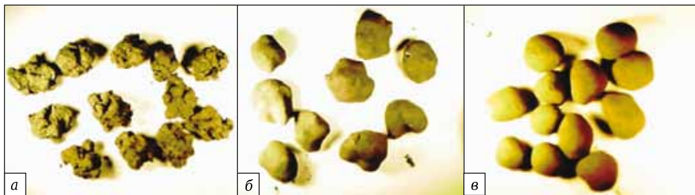
Рис. 7. Гранулы для режущих модулей с разным содержанием алмазов (×3): а — для концентрации алмазных зерен 150–200 (37,5–50 об. %); б — для концентрации 100–150 (25–37,5 об. %); в — для концентрации ≤ 100 (≤ 25 об. %). Концентрация алмазов принимается равной 100, когда зерна занимают ровно 25 % объема рабочего слоя [10]
