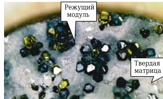
Рис. 6. Фото поверхности излома твердого шлифовального модульного сегмента ( \times 10 ). Относительно темные режущие модули распределены в более светлой безалмазной матрице
