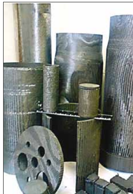
Рис. 2. Корпуса РИТ из УУКМ; длина линейки 250 мм
