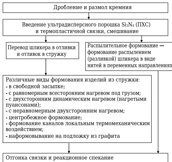
Рис. 3. Технологическая схема получения пористых нитридкремневых материалов формованием элементов из термопластичного шликера
