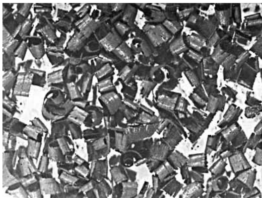
Рис. 2. Стружка из термопластичного шликера
