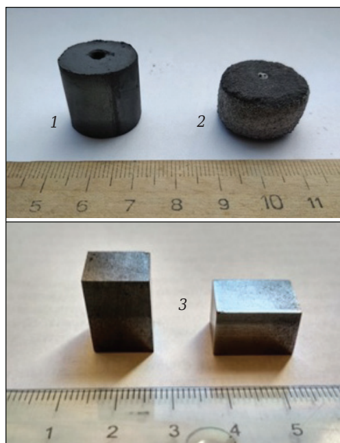
Рис. 3. Фотографии исходного образца (1), продукта ЭТВ (2) и шлифованных образцов (3)
