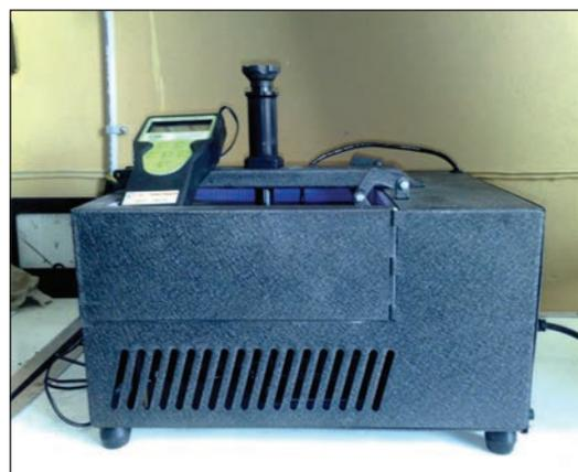
Рис. 2. Измеритель теплопроводности ИТП-МГ 4 «250»
