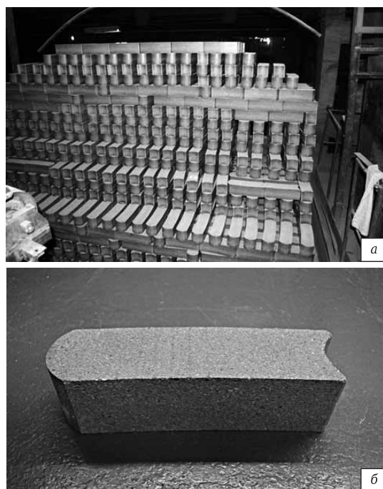
Рис. 1. Внешний вид оптимизированных муллитокремнеземистых изделий: а — продукция перед обжигом в туннельной печи; б — модернизированный дизайн
