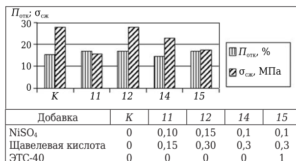
Рис. 4. Результаты физико-механических испытаний образцов составов 11, 12, 14 и 15 с модифицирующими добавками ФФС ( \text{NiSO}_4 , ЭТС-40 и щавелевая кислота)
