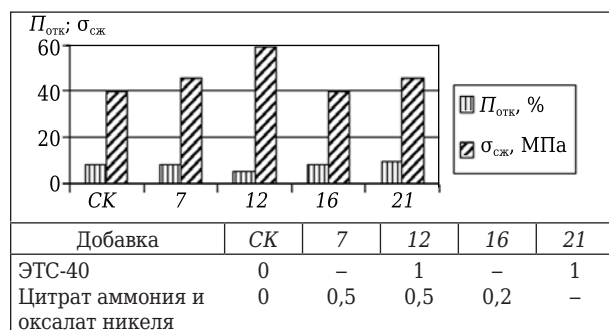
Рис. 5. Результаты физико-механических испытаний образцов составов 7, 12, 16 и 21 с модифицирующими добавками ФФС (соосажденная соль цитрата аммония и оксалата никеля и ЭТС-40); СК — контрольный образец без модификатора
