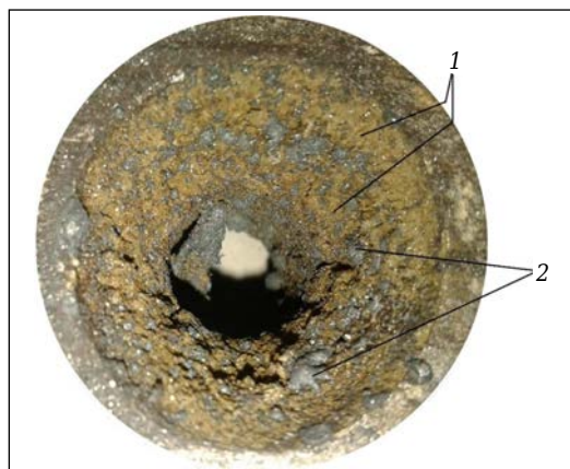
Рис. 4. Фрагменты (1) рабочего слоя футеровки промежуточного ковша, отложившейся на калибровочной вставке нижнего стакана-дозатора, и металлические включения (2)
