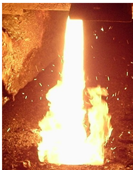
Рис. 3. Дефект типа «веер» струи металла вследствие наличия отложений на внутренней поверхности калибровочной вставки стакана-дозатора
