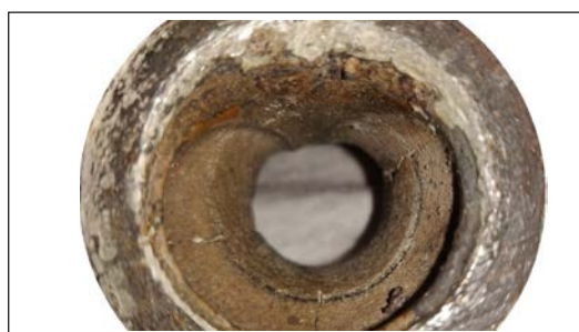
Рис. 5. Циркониевая вставка с неравномерным размытием калибровочного канала
