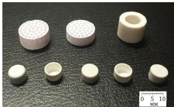
Рис. 3. Образцы изделий из порошков оксида алюминия
