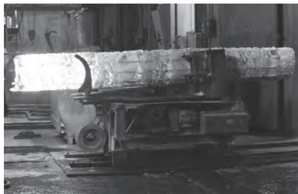
Рис. 2. Блок плавленного кварца, полученный на плазменном реакторе
