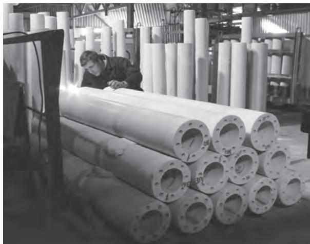
**Рис. 3.** Оболочки роликов печей для термообработки специальных марок листовой стали, полученные на основе ВКВС плавленного кварца центробежным методом
