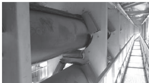
Рис. 1. ТЛК TAKRAF от силосного склада золы на золоотвал сухого складирования Рефтинской ГРЭС (ОАО «Энел Россия»)
