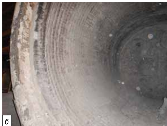
Рис. 9. 380-т сталеразливочный ковш: а — собранный перед эксплуатацией; б — перед ломкой футеровки после достижения стойкости 102 плавки
