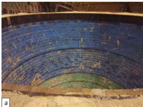
Рис. 9. 380-т сталеразливочный ковш: а — собранный перед эксплуатацией; б — перед ломкой футеровки после достижения стойкости 102 плавки
