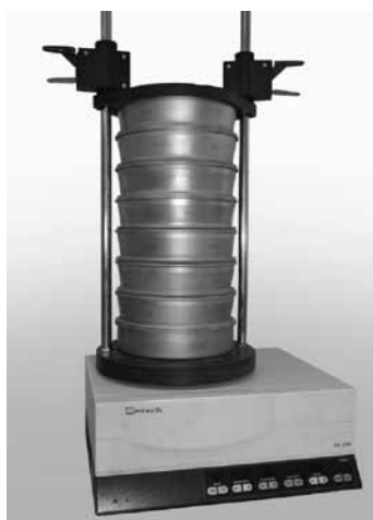
Рис. 2. Аналитическая просеивающая машина AS-200 фирмы «Retsch»
