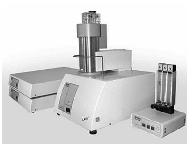
Рис. 12. Термоанализатор «STA 409PGLuxx» фирмы «Netzsch»
