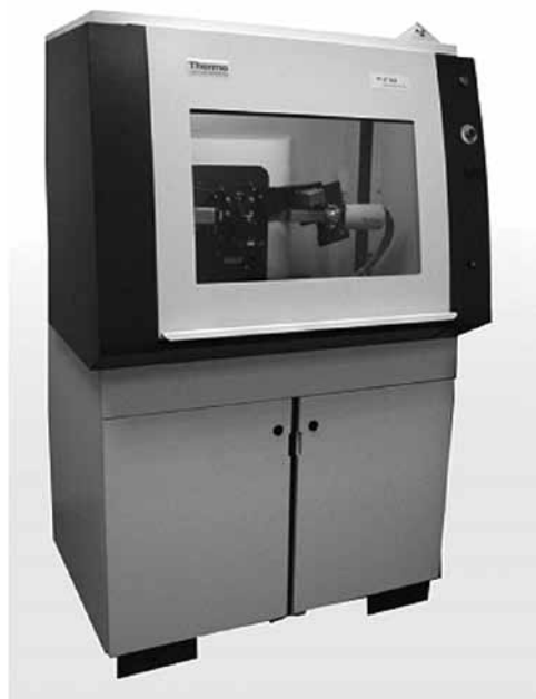
Рис. 10. Рентгеновский дифрактометр «X'tra» фирмы ARL
