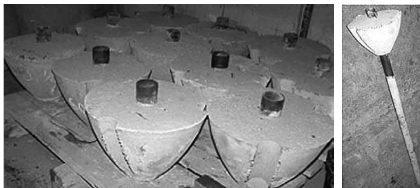
Рис. 3. Огнеупорные изделия для отсечки шлака (конус)
