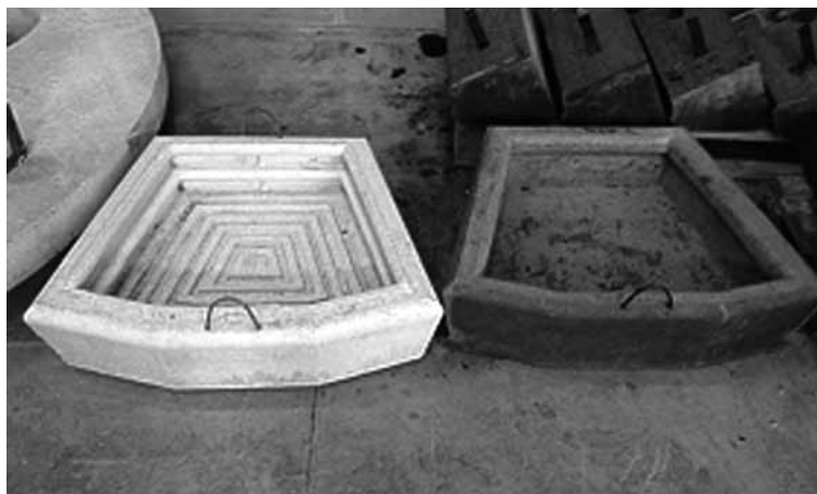
Рис. 5. Металлоприемники «рейнстрим™»: слева — высокоглиноземистый; справа — периклазовый
