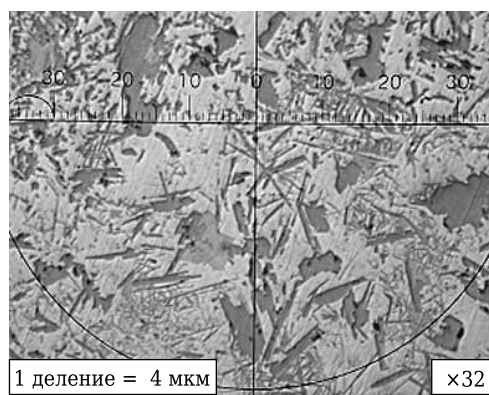
Рис. 3. Микроструктура дефектного слоя образца реакционно-связанного B_4C
