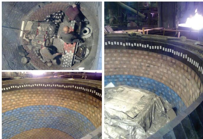
**Рис. 4.** Сборка сталеразливочного ковша
