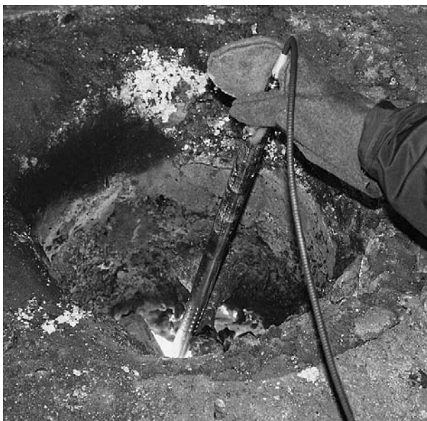
Рис. 1. Измерение температуры расплава стали в индукционной печи
