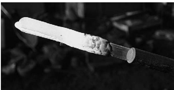
Рис. 2. Чехол после службы в расплаве металла
