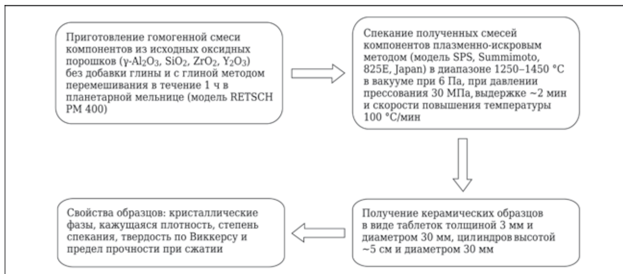
Рис. 3. Схема приготовления смесей компонентов, их спекания и получения керамических образцов, определения их свойств
