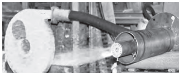
Рис. 2. Скоростная горелка ГНБ в установочной обойме
