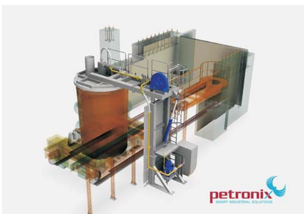
Рис. 4. Вертикальный стенд марки «PETRONIX» сушки и разогрева футеровки сталеразливочных ковшей
