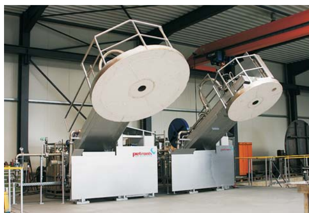
Рис. 4. Вертикальный стенд марки «PETRONIX» сушки и разогрева футеровки сталеразливочных ковшей
