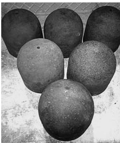
Рис. 4. Шамотнографитовые стопорные пробки для непрерывной разливки стали
