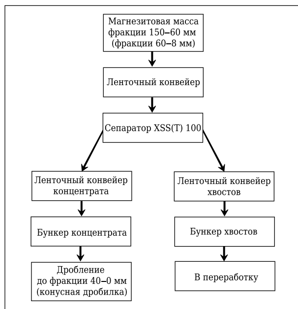
Рис. 2. Принципиальная схема работы сепаратора XSS(T) 100
