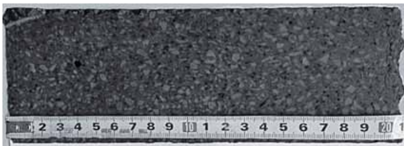
Рис. 1. Фотография периклазогерцинитового изделия после службы
