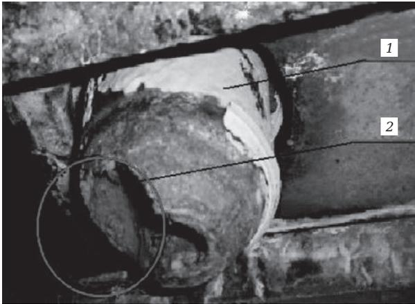
Рис. 2. Эрозия стакана-коллектора (1); 2 — зона эрозии
