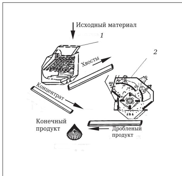
**Рис. 2.** Однооперационная схема выделения твердых включений из глины: 1 — сепаратор; 2 — роторная дробилка
