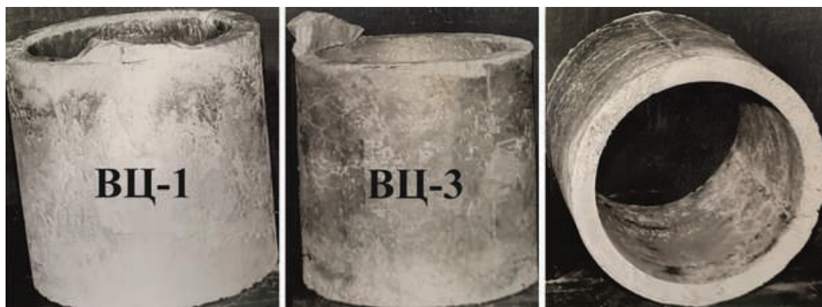
Рис. 4. Плавнелитые кольцевые изделия из высокоциркониевых огнеупоров
