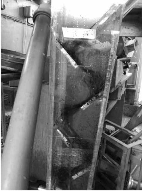
**Рис. 2.** Процесс отмывки никелевого шлака (расход воды 38 м<sup>3</sup>/мин)
