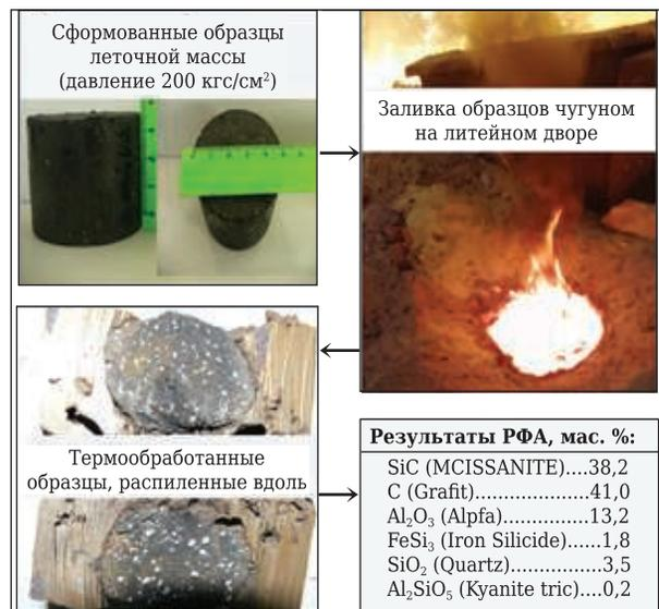
Рис. 5. Схема исследований образцов леточной массы с нитридом ферросилиция
