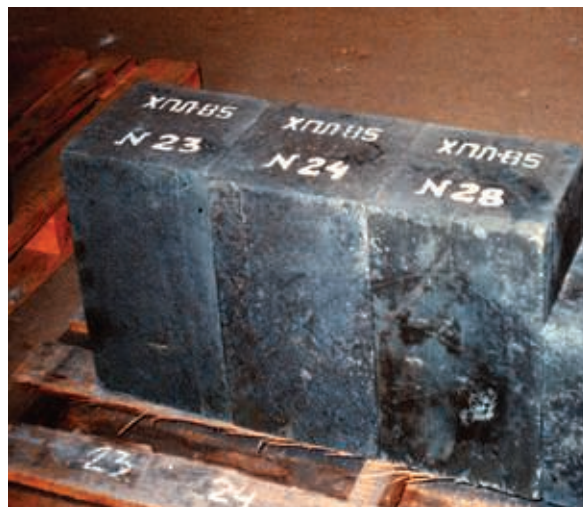
Рис. 1. Промышленные брусья (600×400×250 мм) огнеупора ХПЛ-85
