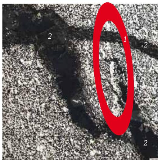
Рис. 9. Микроструктура гарнисажа разновидности 5 (образец Г10). Образец состоит из двух разновозрастных систем микротрещин: первичная (обозначена овалом), заполненная преимущественно КНТВ 1, и более поздние вторичные 2, залитые шлаковым расплавом; белое — КНТВ; серое — шлаковые силикаты. Следует отметить, что первичные трещины переходят во вторичные (нижняя часть снимка), а вторичные трещины пересекают первичные, обогащенные КНТВ. \times 100 . Свет отраженный
