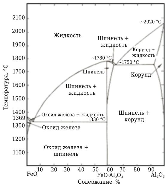
Рис. 5. Равновесная диаграмма состояния системы  $\text{FeO}-\text{Al}_2\text{O}_3$  [9]
