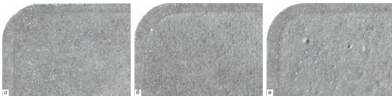
Рис. 3. Морфология поверхностей керамических пластин BOK71 после УАВ при режиме: а — P = 1,5 ат, \tau = 11 с; б — P = 2 ат, \tau = 22 с; в — P = 2,5 ат, \tau = 33 с ( \times 40 )
